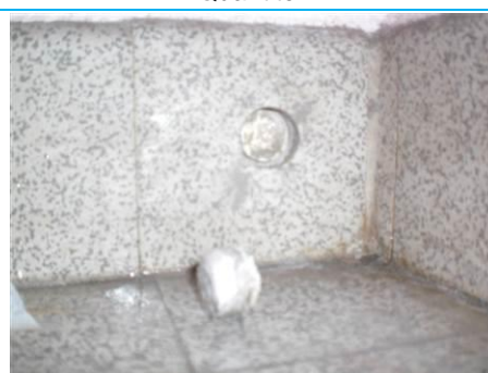
Matériaux : ZPSO-P01 Prélèvement : P110; P124 Description : Colle de plinthes 10*10 cérame gris Localisation : RdC - 004; RdC - 020 Résultat : Absence d'amiante Quantité :
