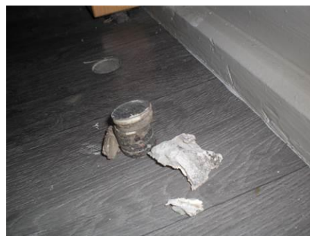
Matériaux : ZPSO-S09 Prélèvement : P116 Description : Colle noire sous ragréage et sol souple Localisation : RdC - 023; RdC - 027 Résultat : Présence d'amiante Quantité : 30
