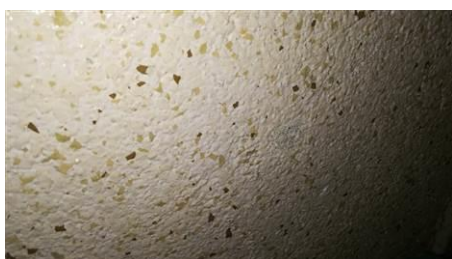
Matériaux : ZPSO-M08 Prélèvement : P150; P163 Description : Peinture pailletée blanc crème Localisation : R1 - 035; R1 - 030 Résultat : Absence d'amiante Quantité : m2
