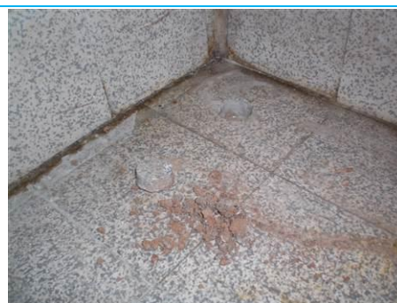
Matériaux : ZPSO-S06 Prélèvement : P109 Description : Colle de carrelage grès cérame 10*10 gris Localisation : RdC - 004; RdC - 020; RdC - 016 Résultat : Absence d'amiante Quantité :
