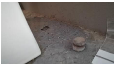
Matériaux : ZPSO-S18 Prélèvement : P144 Description : Colle de carrelage gris et ragréage sous lés souples Localisation : R1 - 018; R1 - 034; R1 - 032; R1 - 025 Résultat : Absence d'amiante
