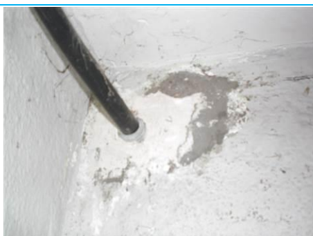
Matériaux : ZPSO-M04 Prélèvement : P161 Description : Enduit de calfeutrement ciment et plâtre Localisation : RdC - 036b Résultat : Absence d'amiante Quantité :
