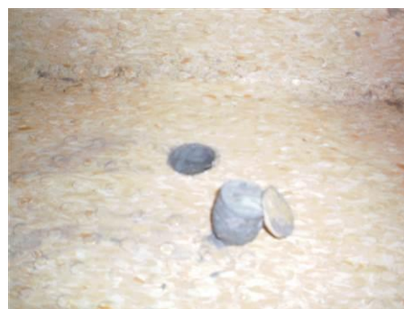
Matériaux : ZPSO-S04 Prélèvement : P102; P106 Description : Colle de carrelage gris et ragréage sous tarkett douche Localisation : RdC - 034; RdC - 010; RdC - 003; RdC - 009; RdC - 033 Résultat : Absence d'amiante Quantité :
