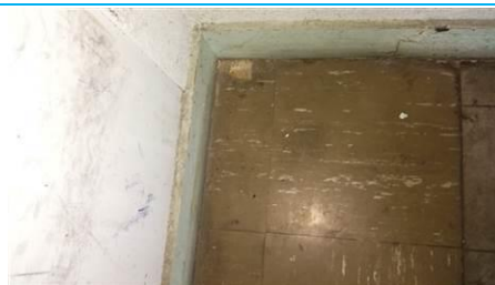
Matériaux : ZPSO-S02 Prélèvement : P155 Description : Dalle de sol 30*30 marron et colle jaune Localisation : RdC - 014 Résultat : Présence d'amiante Quantité : 3ml
