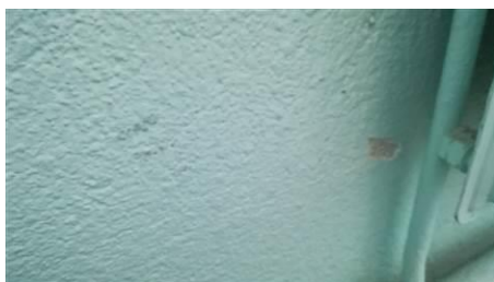
Matériaux : ZPSO-M07 Prélèvement : P147 Description : Peinture pailletée verte Localisation : RdC - 040; R1 - 029; R1 - 028 Résultat : Absence d'amiante Quantité :
