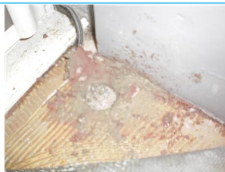
Matériaux : ZPSO-S10 Prélèvement : P120; P126 Description : Colle, ragréage et sol souple façon parquet Localisation : RdC - 028; RdC - 024 Résultat : Absence d'amiante Quantité :
